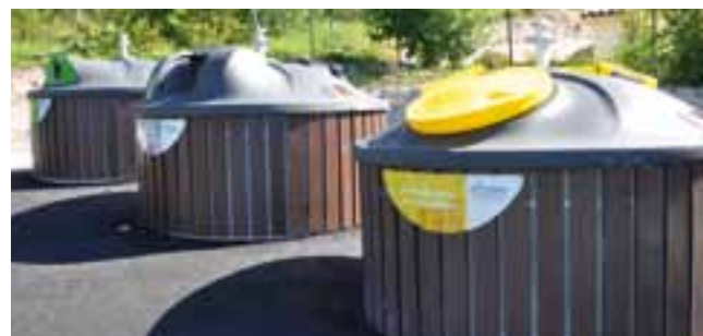
Des bornes enterrées sont déjà en place impasse des Aubépines : il s'agissait ici de résoudre la problématique de circulation des bennes sur des voies étroites.
